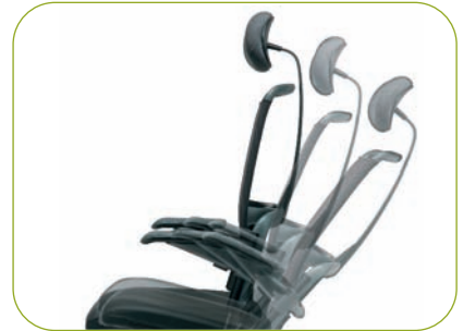
Die Synchronmechanik (Typ 51) verfügt über einen Öffnungswinkel von 93° bis 123°. Verhältnis 1:2,9.
