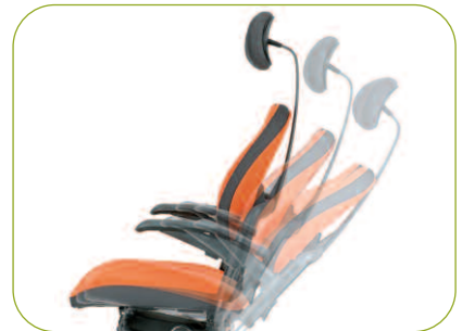
Synchronmechanik mit einem Öffnungs- winkel von 98° bis 121,5°. Verhältnis 1:2,9.
