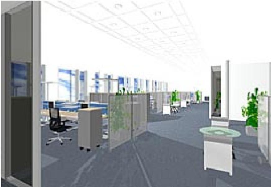
Der Fußboden ist mit einem Teppich belegt, die Decke ist aus glattem Beton, denn sie soll Wärmeaustausch ermöglichen. Die Wände bestehen aus Beton und Gipskarton. Die Möbeloberflächen sind aus Melamin.
